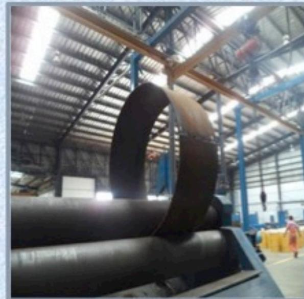
NUESTRAS ROLADORAS ESPECIALES PUEDEN ROLAR PLACA DE ACERO DE HASTA 2.0 M DE LARGO PARA CAMISAS DE REFUERZO CON DIAMETRO DE HASTA 48"
